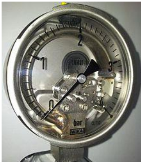
Figura 2-3 Manômetro com mostrador transparente mostrando o Tubo Bourdon
